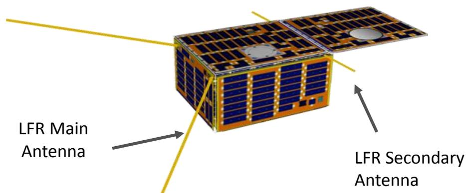
Figure 4-1 MASCOT-2 Lander LFR subsystem [Błąd! Nie można odnaleźć źródła odwołania.]
