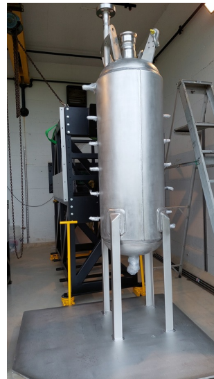
(d) LCH4 pressure vessel
